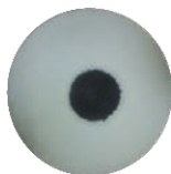
Slika 4.3: Slika oduvane površine pri pritisku od 2 bar, sa visine od 200 mm za debljinu praha od 1 mm
