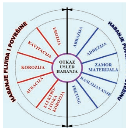
Slika 3. Mehanizam negativnog uticaja kontaminanata na fluid, komponente i rad reduktorskog sistema[5]
