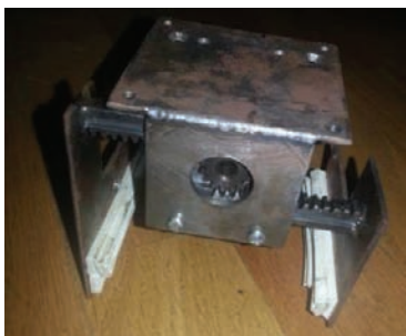
Slika 4 – Primer hvataljke za zupčastim letvama
