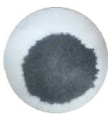
Slika 4.1: Slika oduvane površine pri pritisku od 6 bar, sa visine od 200 mm za debljinu praha od 1 mm
