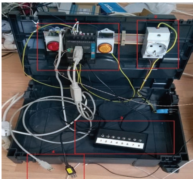
Slika 4. Maketa upravljačke stanice: 1.PLC sa komunikacionom karticom i signalnim diodama, 2.priključak za napajanje PLC-a, 3.prekidači za izbor režima rada postrojenja, 4.USB priključci za komunikaciju i programiranje.
