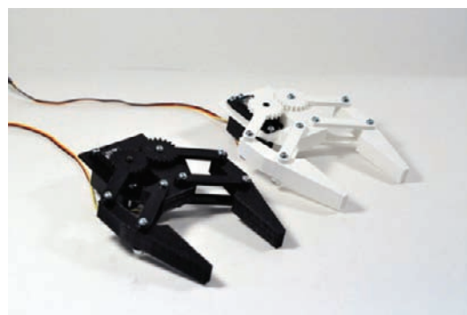
Slika 3 – Hvataljka izrađena uz pomoć 3D štampe
