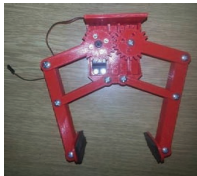
Slika 11 – Model hvataljke ostvaren uz pomoć 3D štampe
