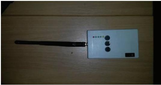
Slika 11 – Uređaj za upravljanje bespilotnom letelicom
