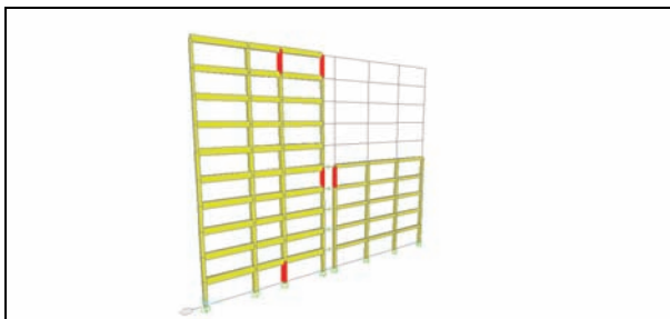
Slika 1: Proračunski model konstrukcija, sa obeleženim i detaljnije analiziranim stubovima
