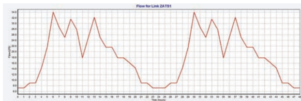
Slika 5. Dijagram promene protoka u deonici ZATS1
