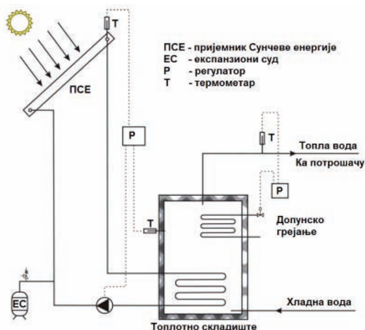
Слика 4. Систем са ПСЕ и једним складишником топлоте и допунским извором за грејање
