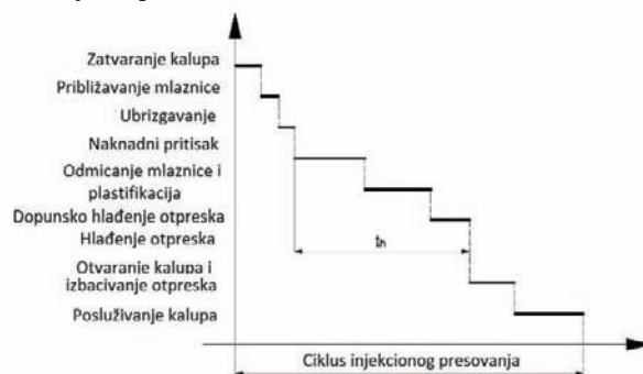
Slika 2. Ciklus brizganja termoplasta [3]
