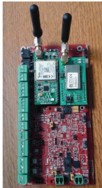
Слика 2. Концентратор са прикљученим комуникационим модулима.
