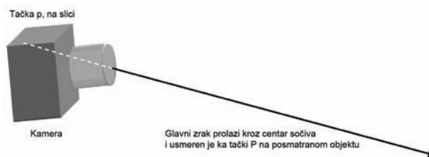
Slika 1. Korišćenje kamere koja određuje pravac u prostoru [3]
