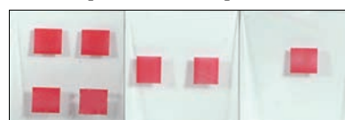
Slika 5. Uzorci stakla odštampani tamponom 1, tamponom 2 i tamponom 3
