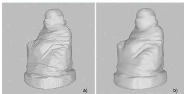
Slika 6. Faze generisanja 3D modela – a) rezultat prve faze generisanja modela, b) rezultat optimizacije
