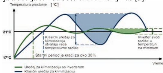
Slika 5. Razlike u radu konvencionalnih i invertorskih klima uređaja
