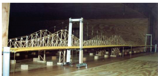
Slika 6. Model visećeg mosta u vazдушnom tunelu
