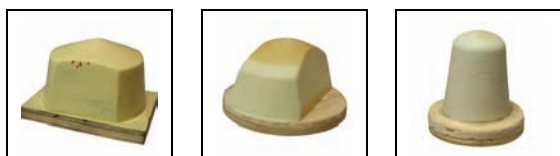
Slika 2. Tamponi korišćeni u procesu štampe: a) Tampon 1 (10 Shore A); b) Tampon 2 (5 Shore A); c) Tampon 3 (2 Shore A)
