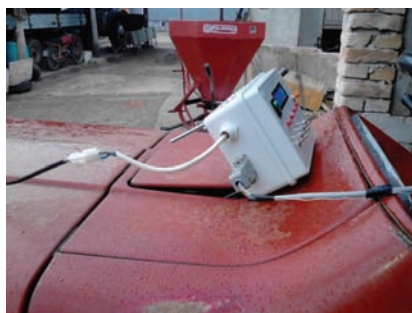
Slika 10. Glavna kutija sa izvodom za napajanje i priključenim 9-to žilnim kablom
