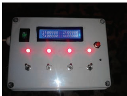
Slika 11. Početno stanje na senzorima i isključena sva 4 prekidača
