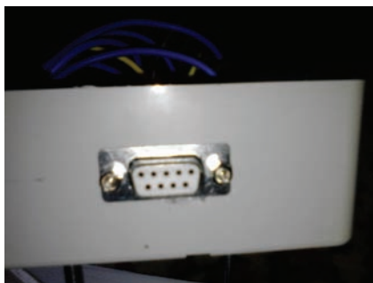
Slika 9. Razvodna kutija i ženski konektor SUB 9
