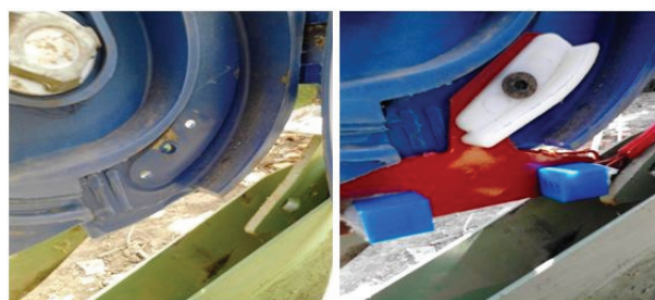
Slika 8. Prikaz baterije bez i sa senzorima
