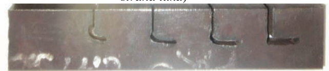
Slika 12. Rezovi na Č 4732 h=20 mm v=const (izlazna strana luka)
