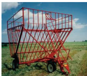
Slika 3. Samoistovarna prikolica za konvencionalne bale, koju vuče presa
