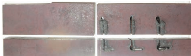
Slika 11. Rezovi na Č 0361 h=20 mm v=const (izlazna strana luka)
