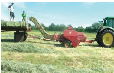
Slika 1. Utovar konvencionalnih bala direktno iz prese u prikolicu pomoću kliznica
