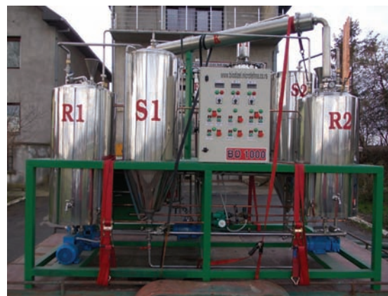
Slika 3: Postrojenje za proizvodnju biodizela, model BD1000 (kapaciteta 1000 lit/dan, proizvođač: NiCrOTEHNA) [5]
