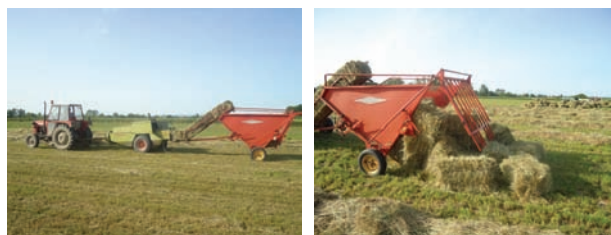
Slika 4. Prikolica-akumulator „Mathiaut“ pri ispitivanju procesa sakupljanja i istovara bala sena
