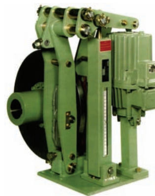
Slika 3. Usvojena disk kočnica sa kočno – otkočnim uređajem ELDRO
