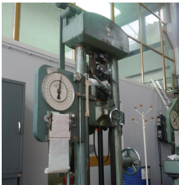
Slika 4. Mehanička kidalica, VEB ZDM 5/91
