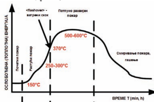
Слика 5. Основне фазе развоја пожара код дрвених конструкција [2]
