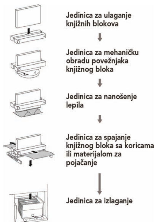
Slika 1 - Osnovni delovi mašine za bešavni povez
