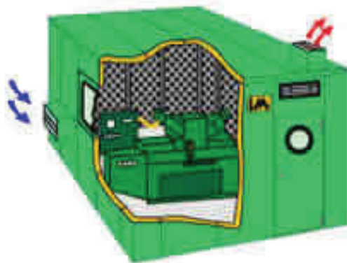
Slika 2. Mašina ograđena kabinom [2]
