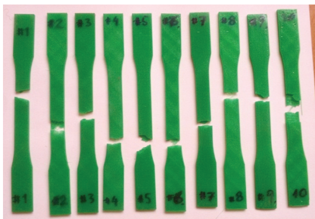
Slika 5. Deset epruveta nakon završenog merenja na kidalici
