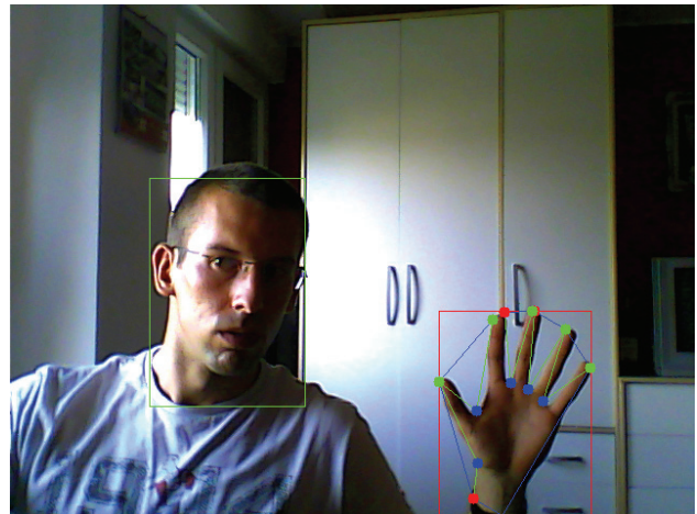
Slika 4. Lice i šaka detektovani, izdvojeni kontura, konveksna obvojnica i locirana konveksna odstupanja
