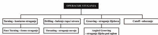
Slika 4. Tipski zahvati struganja u SolidCAM-u
