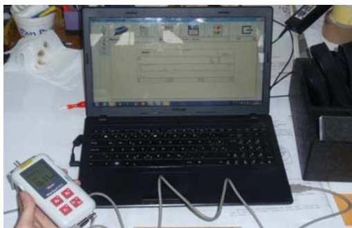
Sl. 7. Povezivanje MahrSurf aparata sa računarom pomoću USB priključka
