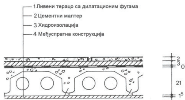
Slika 1: Teraco pod, slojevi
