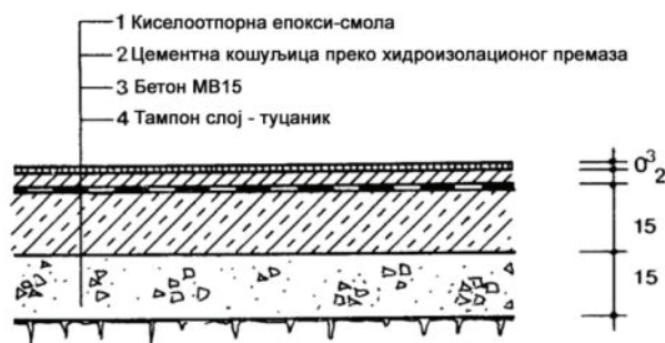
Slika 6. Liveni pod na bazi епокси-смоле
