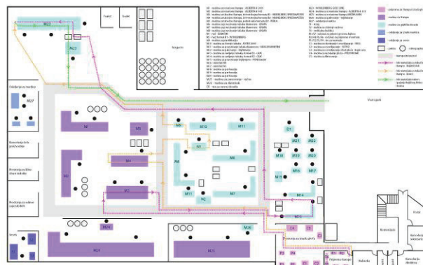
Slika 2. Prostorna struktura sa transportnim putevima i tokovima materijala za proizvode koji se povezuju lepljenjem - predlog
