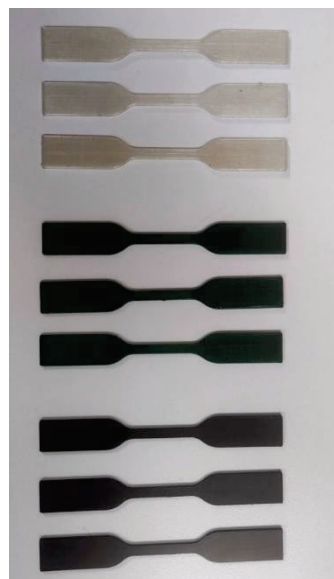
Slika 4. Epruvete izrađene od različitih recikliranih filamenata PET plastičnih boca
