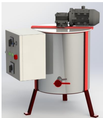
Slika 1 - 3D model idejnog rešenja automatizovanog miksera za krem med
